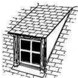
lucarne rampante ou en chien couché
