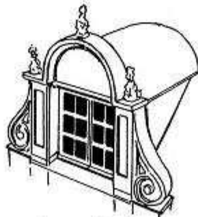
lucarne-fronton ici à ailerons et toit bombé
